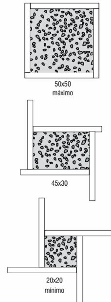
Les Piliers Métalliques de la Série Légère DERCONS sont utilisés pour la réalisation de piliers de manière modulaire. Sa flexibilité permet d'effectuer des piliers de différentes sections, allant de 20x20cm jusqu'à 50x50cm, avec la possibilité de changer de section chaque 5 cm
